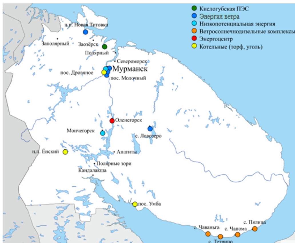
Рис. 2. Источники распределенной генерации в Мурманской области Fig. 2. Sources of distributed generation in the Murmansk region
