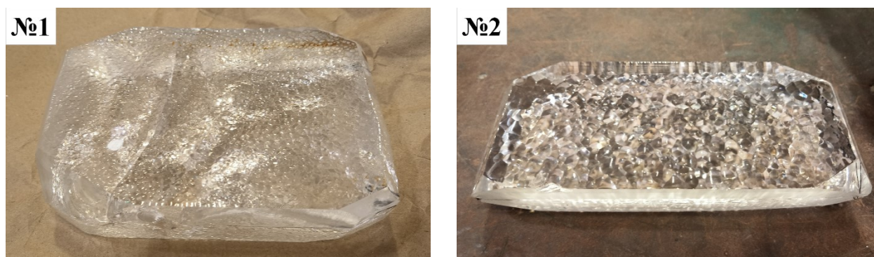
Рис. 3. Формы, особенности поверхности и дефекты образцов синтетического кварца Fig. 3. Shapes, surface features and defects of synthetic quartz samples
